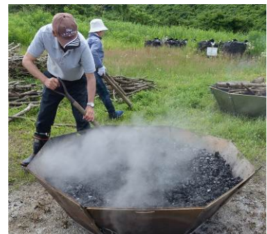
炭材が形を残したまま白くなり、製炭器がいっぱいになったら製炭終了です(上)。水をかけ、かき混ぜながら冷めます。(下)。
