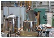
剪定会の 10 日後, 渋谷先生(左)と安藤 先生(右)が剪定枝葉を麻袋4袋にギュウ ギュウに詰め込みます(上)。原理は蒸留 酒の作り方と同じです。釜に装着, 約1時間半かけて抽出します(下)。今回は土嚢 袋9袋, 約22kgを使用しました。
