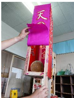
【点火試験】火が安全に保たれるか実験（OK！）。スギ灯り台とロウソクが固定され、斜めにしても引火しないのを確認。夜はほのかな灯りでキレイです。
