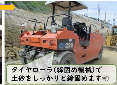
タイヤローラ(締めめ機械)で土砂をしっかり締め固めます⇒
