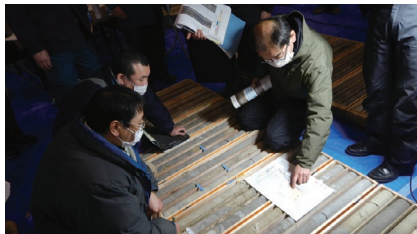
ボーリングコア確認
