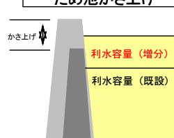
ため池かさ上げ
