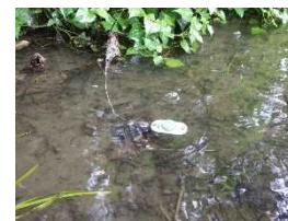
照度計設置状況
