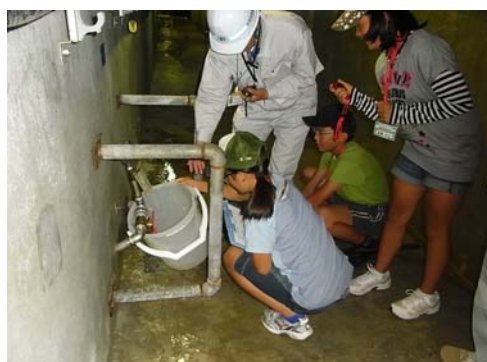
(監査廊での漏水量調査)
