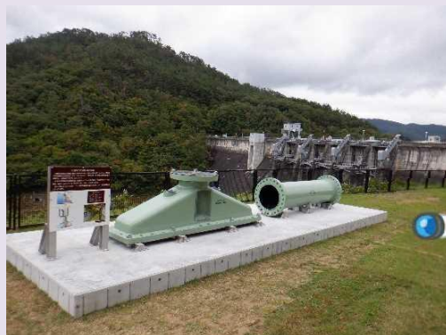
機械遺産実物展示(高圧放流設備)
