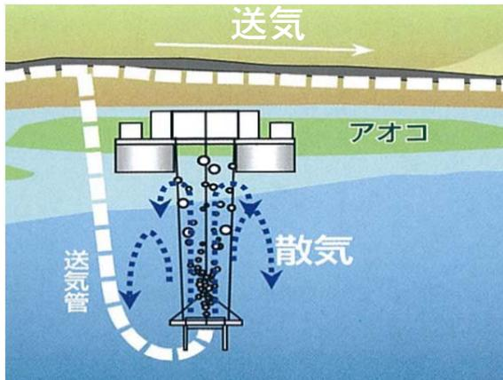
田瀬ダムでは、平成11年頃から夏期を中心にダム湖に植物プランクトンによる「アオコ」が発生するようになり、アオコの発生を抑制するために、貯水池内に曝気装置を設置しています。昨年度1台増強し、今年から4台の体制で稼働しています。
