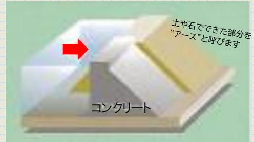
コンクリート部とアース盛立部(土の部分)が隣り合わせの構造となっているため、この部分から水が漏れない工夫が行われています。
