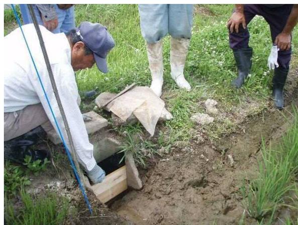
図 7-7 水田貯留（田んぼダム）実証実験の様子
