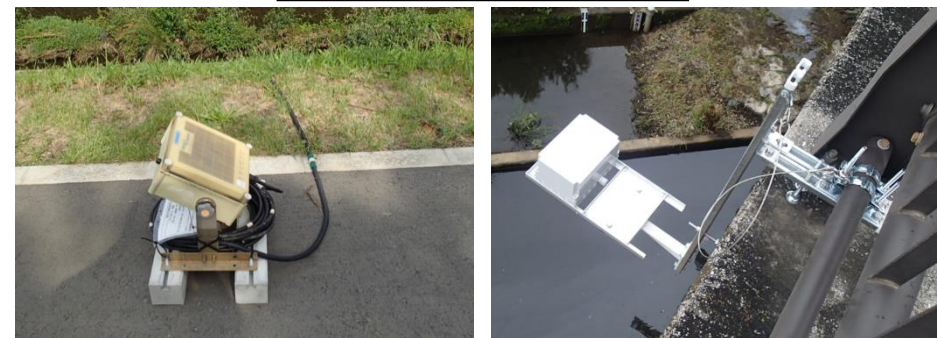
堤防に設置するタイプ （ケーブル（計測器）を河川に入れて計測）
