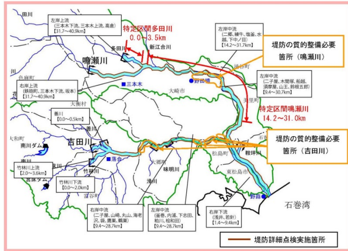
図 5-9 質的整備箇所(鳴瀬川・吉田川)
