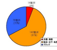
図 2-29 堤防被災箇所における被災状況別箇所数
