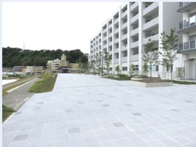
ミディアムグレーを主に、明度の異なる平板ブロックをランダムに配置
