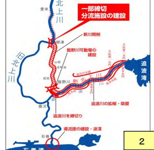
③北上川の新川開削工事[北上川第1期改修工事]
