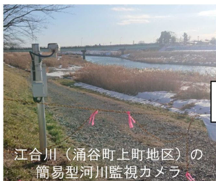
図 11-12 簡易型河川監視カメラの活用イメージ
