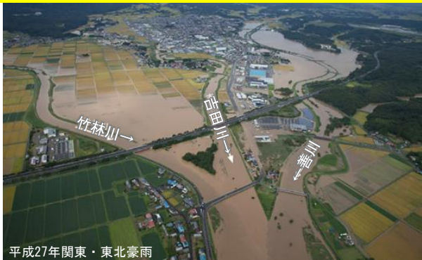
吉田川中流部は、洪水時に河道の水位が上昇しやすく、氾濫の危険性が高い
