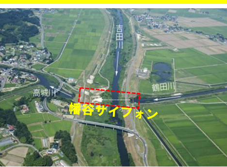
高城川上流部(鶴田川)は、幡谷サイフォンにより流下能力が制御されている
