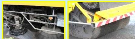
車体横のブラシで土砂をかきだし、後ろのブラシで回収します。
