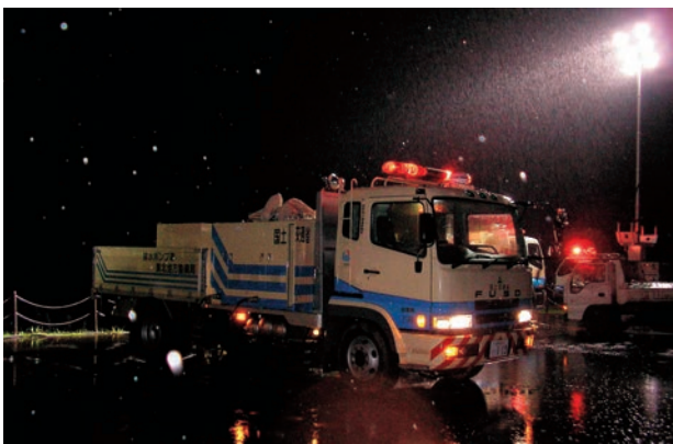
排水ポンプ車による内水排除（花巻市後川地区）
