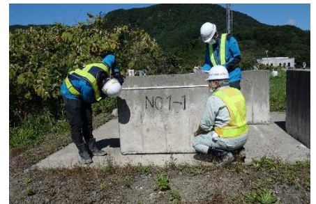
▲大型供試体の形状寸法測定の様子
