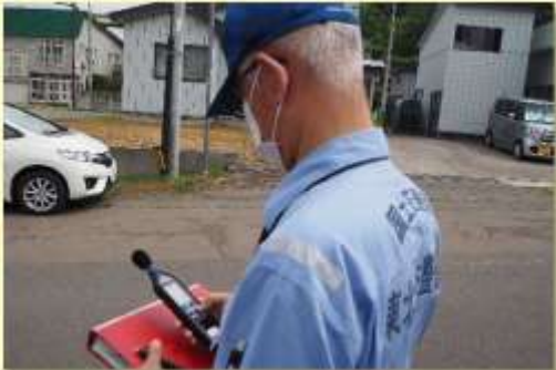
▲警報所スピーカ・サイレンの音量を測定し、目標値をクリアしていることを確認しました
