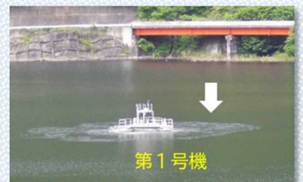
▲稼働開始！スイッチを入れて数分後、装置からブクブクと泡が出てきました。
