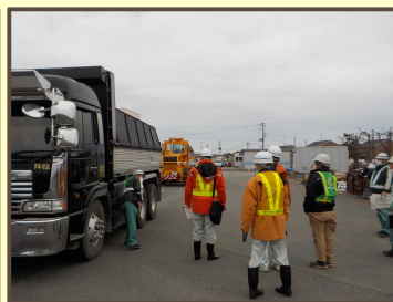
▲スタックした運転手さんと一緒に車両の確認(移動前と移動後での車両損傷の有無を確認するため)
