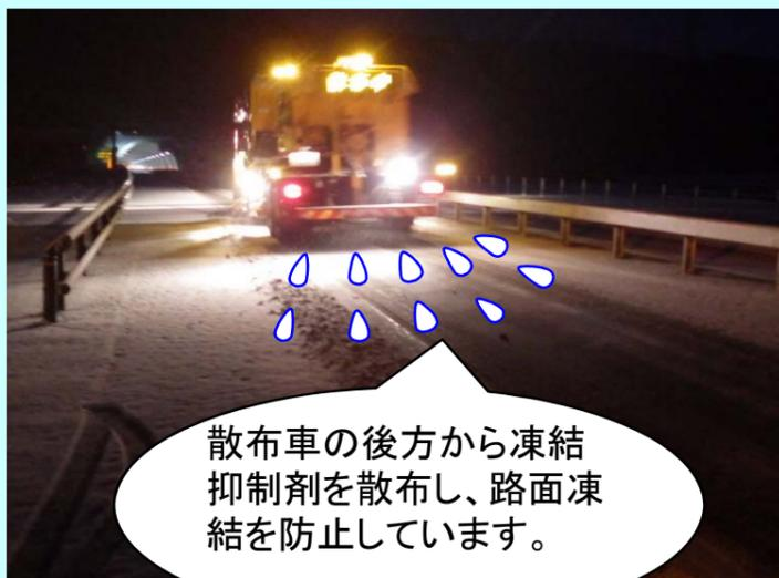
散布車の後方から凍結抑制剤を散布し、路面凍結を防止しています。
