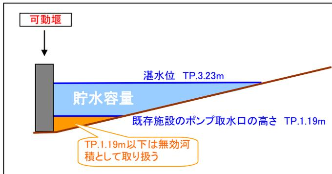
図 可動堰と河床縦断との関係
