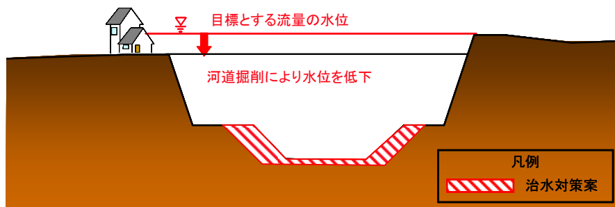
図 4.2-11 掘削断面のイメージ (県管理区間)
