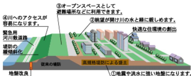
図 4.2-17 高規格堤防イメージ図
