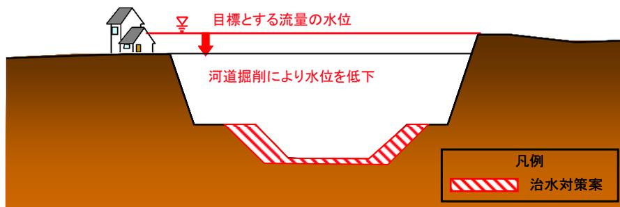
図 4.2-11 掘削断面のイメージ (県管理区間)
