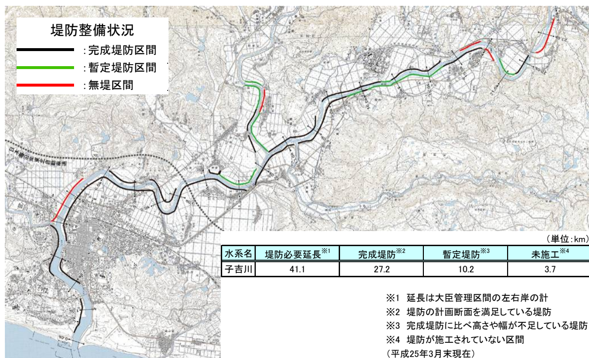
図 2.3-5 堤防整備状況
