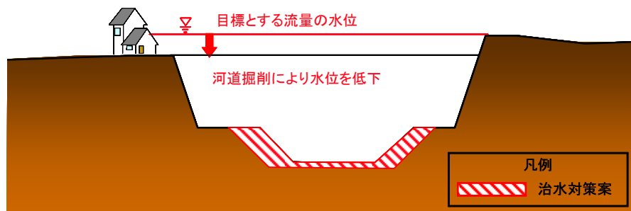
図 4.2-11 掘削断面のイメージ（県管理区間）
