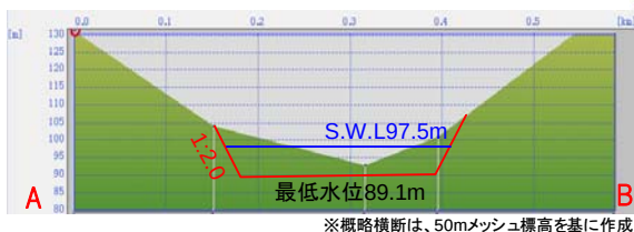
図 掘削断面イメージ
