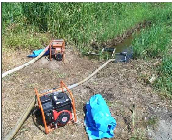
子吉川からの取水中止により かんがい用水を排水路からポンプアップ (平成24年8月 川口下中島揚水機)
