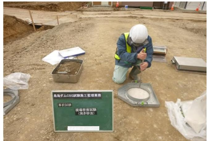
転圧後の密度測定(砂置換法)
