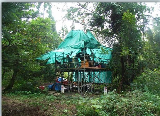
ボーリングマシンを足場に設置し、地表面から地中深くまでロッド(鋼製のパイプ)で掘削し、サンプルを採取していきます。
