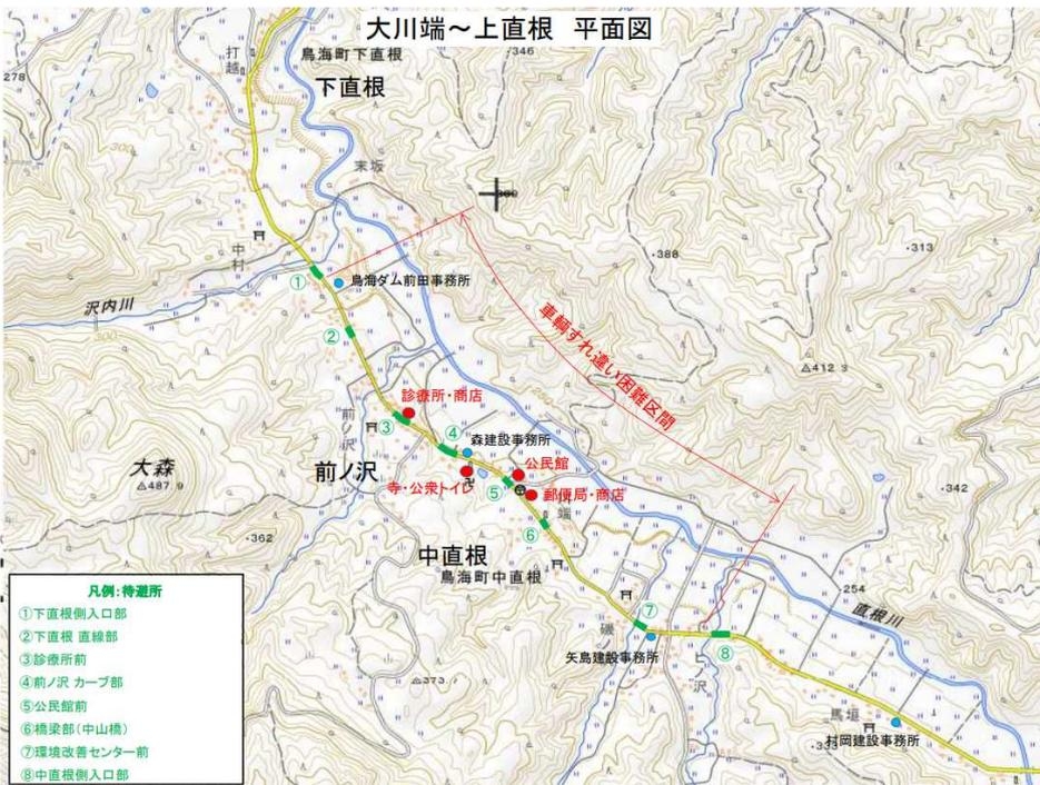
冬期間はトンネル工事のほか、一部橋梁の下部工工事や工事用道路工事を実施しており、コンクリートの打設、土砂運搬や盛土作業を行うため、生コン車、土砂運搬用のダンプトラック、建設重機・資機材運搬の車輛が県道鳥海矢島線を通行いたします。車輛のすれ違いが困難な区間では待避できる場所を確保し、人員を配置して誘導するなど対応いたします。ご協力をお願いいたします。
