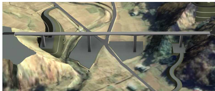
⑥ 橋面工 (橋の表面を車が走りやすいようにアスファルト等で舗装やガードレールを設置し完成です。)
