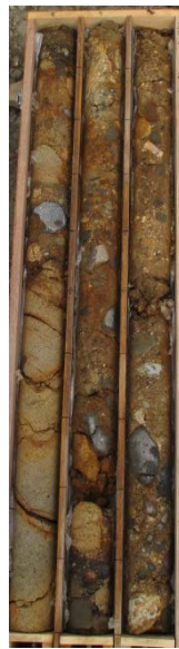
ボーリングコア
