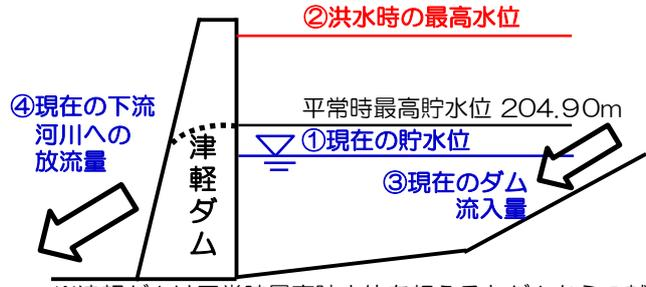
※津軽ダムは平常時最高貯水位を超えるとダムからの越流が開始する自然調節方式のダムです。
