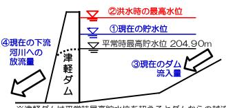
※津軽ダムは平常時最高貯水位を超えるとダムからの越流が 開始する自然調節方式のダムです。
