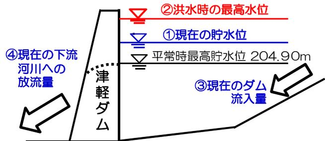
※津軽ダムは平常時最高貯水位を超えるとダムからの越流が開始する自然調節方式のダムです。
