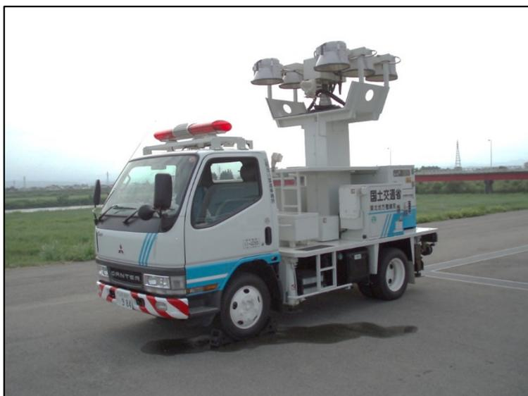
発動発電機、照明装置、照明装置昇降用ポール等を備えた車両で、災害現場・作業現場を延び縮みするポールの先端にあるランプで最大高さ 10m から広範囲に照らすことができます。また、搭載された発電機で電源供給や非常用電源等に使用することができます。
