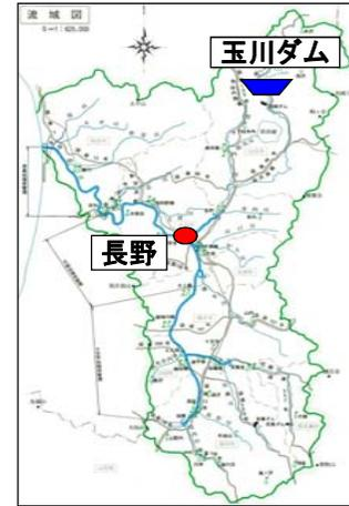
玉川ダムの洪水調節効果により、長野地点の水位が約0.3m低下
