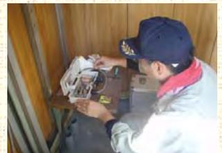
雨量観測所点検とは、月に1回、湯田ダムの上流の雨が集まってくる場所に、囲むように配置されたエリアの山の高い位置に設置している雨量マス(山に降った雨の量を計測して湯田ダムに雨量データを送る機械のことで、高下・桐沢・本内・新町・湯川・ダム地点と6ヶ所の雨量観測所があります。) がしっかり動作をしているか確認・点検をすることです。
