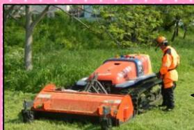
この草刈り機「ジョージ」の操作はリモコンで行っています。操作中は常に四方向に気を配り、方向転換やバックをする際も注意が必要です。石が多い所は刃を傷める可能性があるため草を長めに残して刈ります。刈る草の長さを調節しながら作業を進めます。
