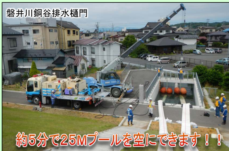
排水ポンプ車訓練の様子 能力:60m 3 /min
