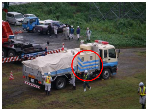
←排水ポンプ車 (赤丸がポンプの操作盤及び発電機です。)
