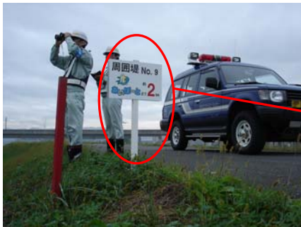
災害時や河川巡視時に点検箇所を把握するために設置した「堤防管理用標識」周囲堤の管理ナンバーと併せて両面にそれぞれ「あいぼーと」までの距離と「あいぼーと」からの距離を表示しました!!
