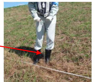
写真ではわかりづらいですが、金属棒はT字型でどれだけ地中に刺さったか分かるよう目盛がついています。
