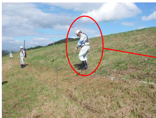
堤防の土が緩んでいないか、堤防の健全度を金属棒を差し込んで確認します。
