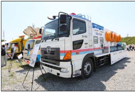
排水ポンプ車(国土交通省)
