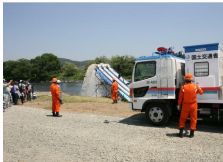
国土交通省による緊急排水作業(ポンプ車)
