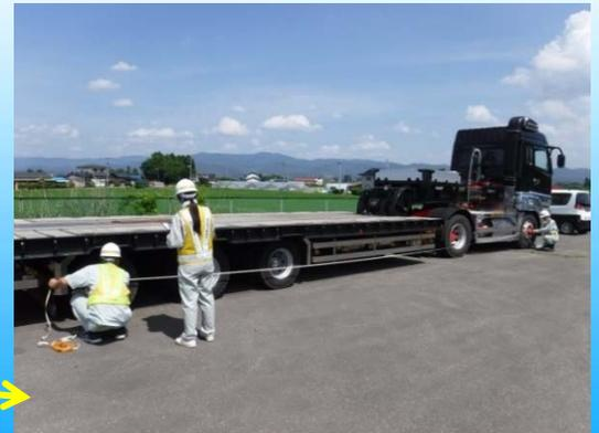
車両の幅や車高が一定基準を超えていないか測定中。
