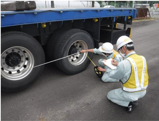
長さ12m(走行状態で)、積載状態で、幅2.5m、高さ3.8m等、車両の構造による限度を超えていないか確認します。(超えている場合は「特殊車両通行許可」が必要です。)
