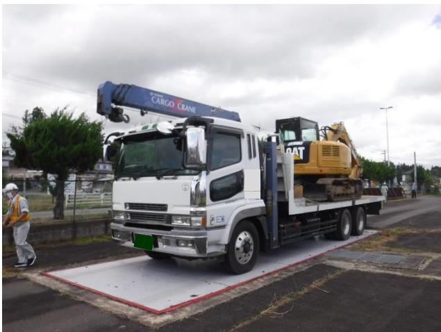
重量(車+乗員+荷物)が基準を超えていないか測定します。
