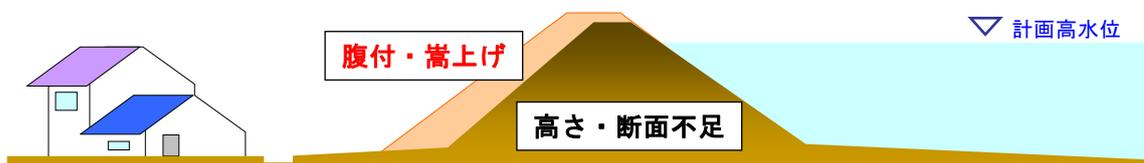
図 5.1.1(2) 堤防の量的整備イメージ（断面不足箇所における堤防の拡築）
